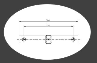
DRY WALL FIX FOR PLASTERBOARD WALL Cod 07181
